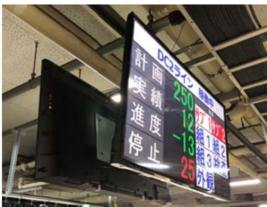
ライン上のモニター設置の様子
